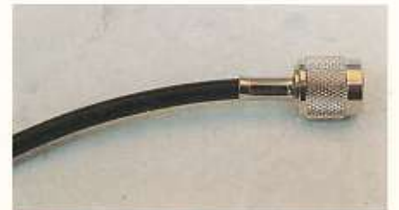
RP-TNC plug na het aanknippen van de huls.
